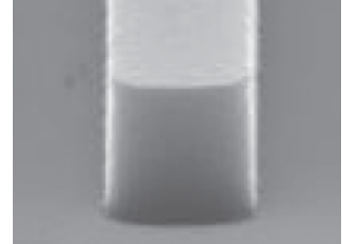
1 μm AZ ® 701 MiR line after 130°C hardbake
