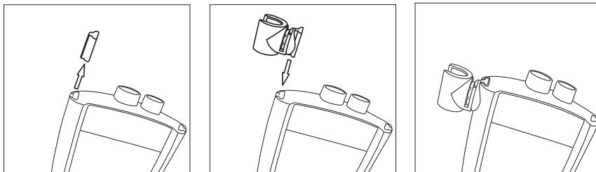
La clip FiveGo™ (cod.51302960) è un portaelettrodo che può essere posizionato al livello del display su entrambi i lati dello strumento. Per montare la clip, rimuovere la protezione dal fermo della clip. Attaccare la clip premendola nell'apposita cavità. Inserire il sensore nella clip dall'alto.
