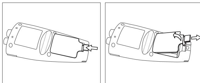
1. Tirare il fermo del coperchio delle batterie in direzione della freccia, tenere il coperchio con due dita
