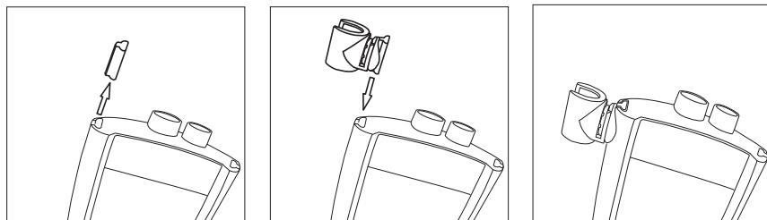
La pinza FiveGo™ (N.º de ref.51302960) es un soporte del electrodo que puede colocarse al lado de la pantalla en cualquiera de los lados de la carcasa. Para montar la pinza, extraiga la cubierta del punto de fijación de la pinza. Coloque la pinza presionando en la cavidad. Deslice desde arriba el eje del sensor por la pinza.
