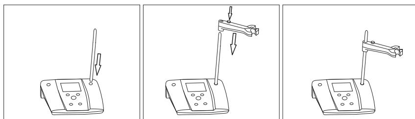
1. Enlevez le cache en caoutchouc du support d'électrode sur le côté de l'instrument de table où vous souhaitez installer le support. Conservez le cache en un lieu sûr ;
