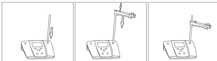
1. ベンチメーター左右のラバーカバーのうち、電極スタンドを取り付ける側を外します。
