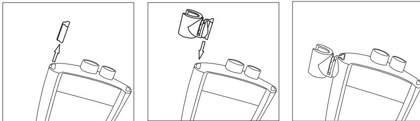
FiveGo™ クリップ (51302960) はハウジングに設けられたディスプレイの両側に取り付けられる電極ホルダーです。クリップを取り付けるには、クリップ取り付け部のカバーを外します。その後、クリップの取り付け部に押し込んで取り付けます。センサーのシャフトをクリップの上側から差し込みます。
