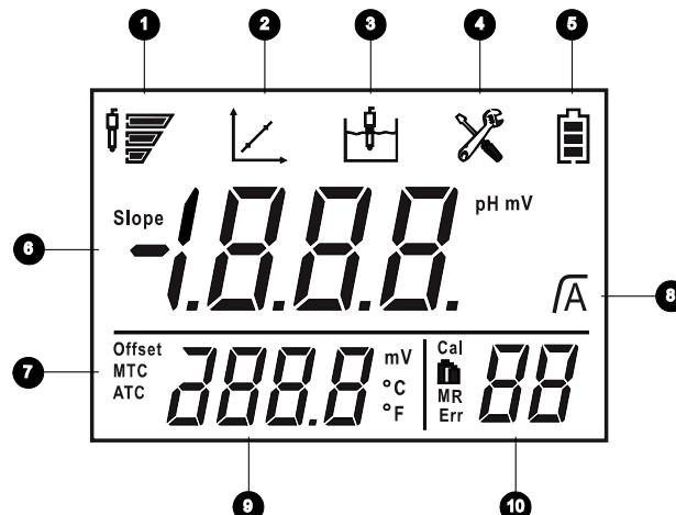
**1** Condizione dell'elettrodo (per la manutenzione dell'elettrodo vedere sezione 5.2)
