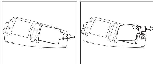
1. Empuje el punto de fijación de la cubierta del compartimiento de las pilas en el sentido de la flecha, aguantando la tapa con dos dedos y retírela;
