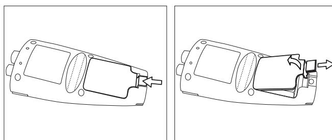
1. Tirez le point de fixation du couvercle de pile dans le sens de la flèche, saisissez le couvercle avec deux doigts et retirez-le ;
