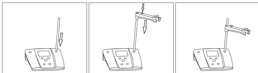
1. Retire la cubierta de goma de la base del electrodo en el lado del medidor de banco donde prefiera colocar la base. Guarde la cubierta en un lugar seguro;
