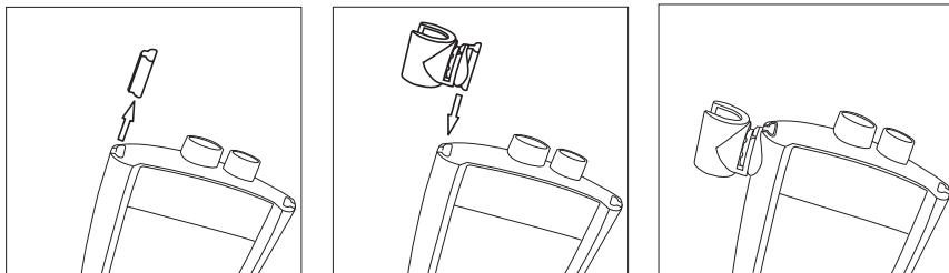
Le clip FiveGo™ (n° de réf. 51302960) est un support d'électrode pouvant être placé à côté de l'afficheur, de chaque côté du boîtier. Pour monter le clip, retirez le cache du point de fixation du clip. Fixez le clip en le pressant dans la cavité. Poussez par le dessus la tige du capteur dans le clip.
