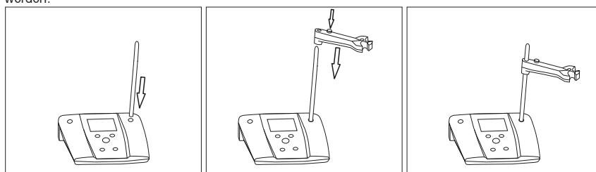
1. Entfernen Sie auf der Seite des Tischmessgerätes, auf der Sie die Halterung anbringen möchten, die Gummibedeckung der Elektrodenstativöffnung. Bewahren Sie die Abdeckung an einem sicheren Ort auf;
