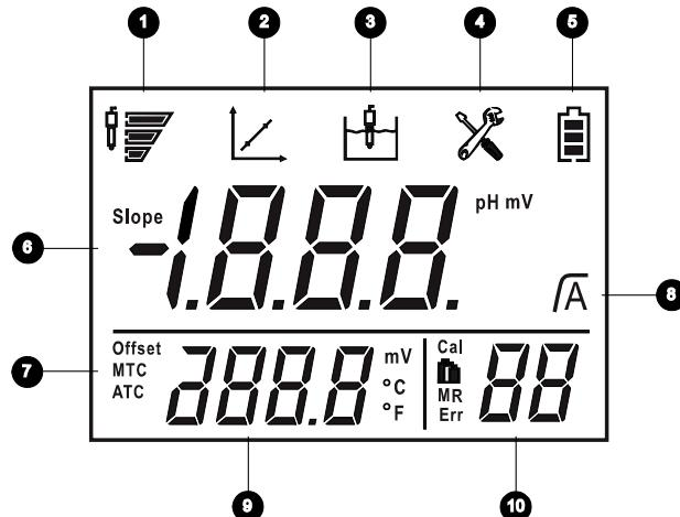
**1** État de l'électrode (pour la maintenance de l'électrode, voir paragraphe 5.2)
